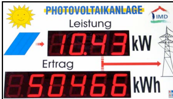
Bild 1: Beispiel für die Leistungsanzeige einer Photovoltaikanlage auf einem Schulgebäude
